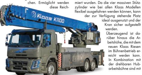
weiten durch die neu entwickelte Außenschiene im 100%igen Alu-Mastsystem, Auf Basis des Klaas Rührreibschweißverfahrens wurde eine Schiene für Belastungsbereiche konzipiert, die sonst nur von Stahlschienen gewährleistet werden können.
