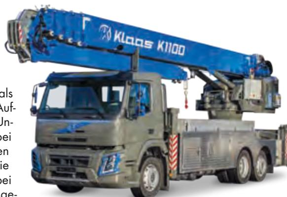
K1100 der ideale Mobilkran für Arbeiten an hohen Gebäuden sowie an großen Dach- und Wandflächen, wenn nur wenig Aufbaufläche zur Verfügung steht.
