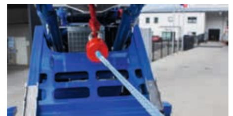
Das Hubseil aus hochwertigem Kunststoff spart Gewicht und optimiert das Hubverhalten.
