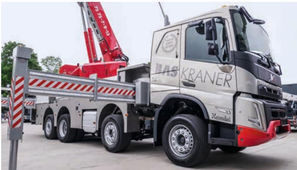
Die hohe Standfestigkeit des 32-Tonnners sorgt für konstante Reichweiten über die gesamte Drehbarkeit des Krans.
