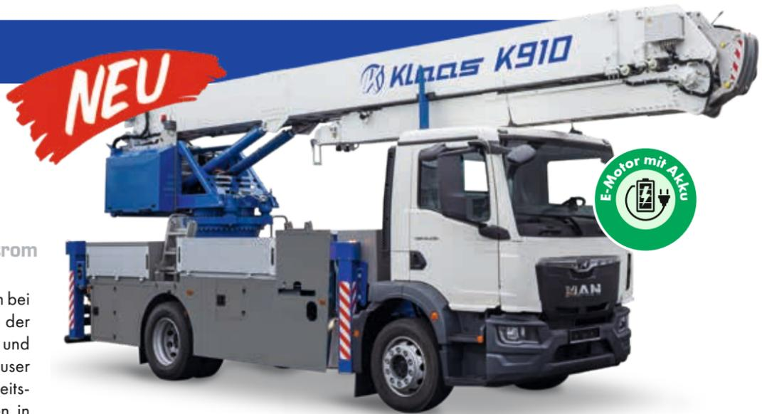
der K910 E auch bei geringem Platzangebot standsicher aufgebaut werden. Der Radstand von nur 4,13 m ist für einen Kran mit einer Hakenhöhe von fast 40 m äußerst gering und verleiht dem Gerät kompakte Abmessungen sowie eine hohe Wendigkeit.
