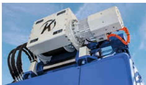
Die elektrische Hubwinde gewinnt beim Absenken der Last Energie.
