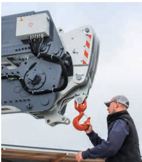
Der zweite Kranhaken ist direkt im Mast integriert.
