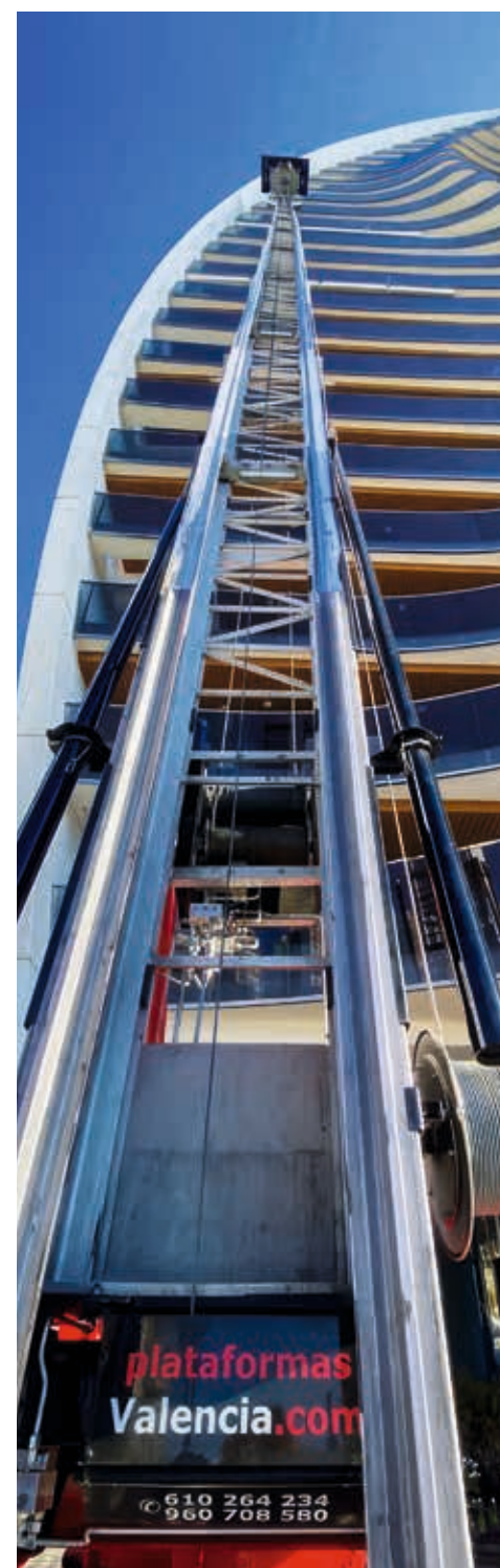
Förderhöhen bis zu 56 m sind mit dem Bigmover möglich.
