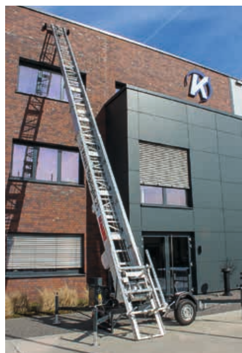
Der Toplight 25 schafft eine Förderhöhe von 25 m.
