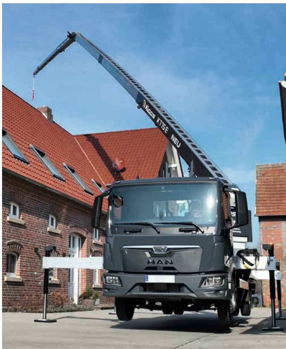
Die stabile H-Abstützung mit einer maximalen Abstützbreite von 6,23 m sorgt für einen standsicheren Aufbau.
