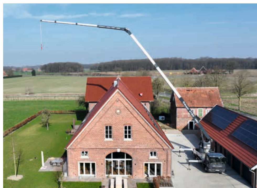
Durch den kurzen Oberwagen bleibt der K775 E innerhalb der Spiegelkontur und arbeitet dadurch besonders platzsparend.
