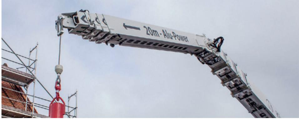
Dank der dreifach hydraulisch teleskopierbaren Klappspitze ist der K2500 sehr flexibel einsetzbar.
