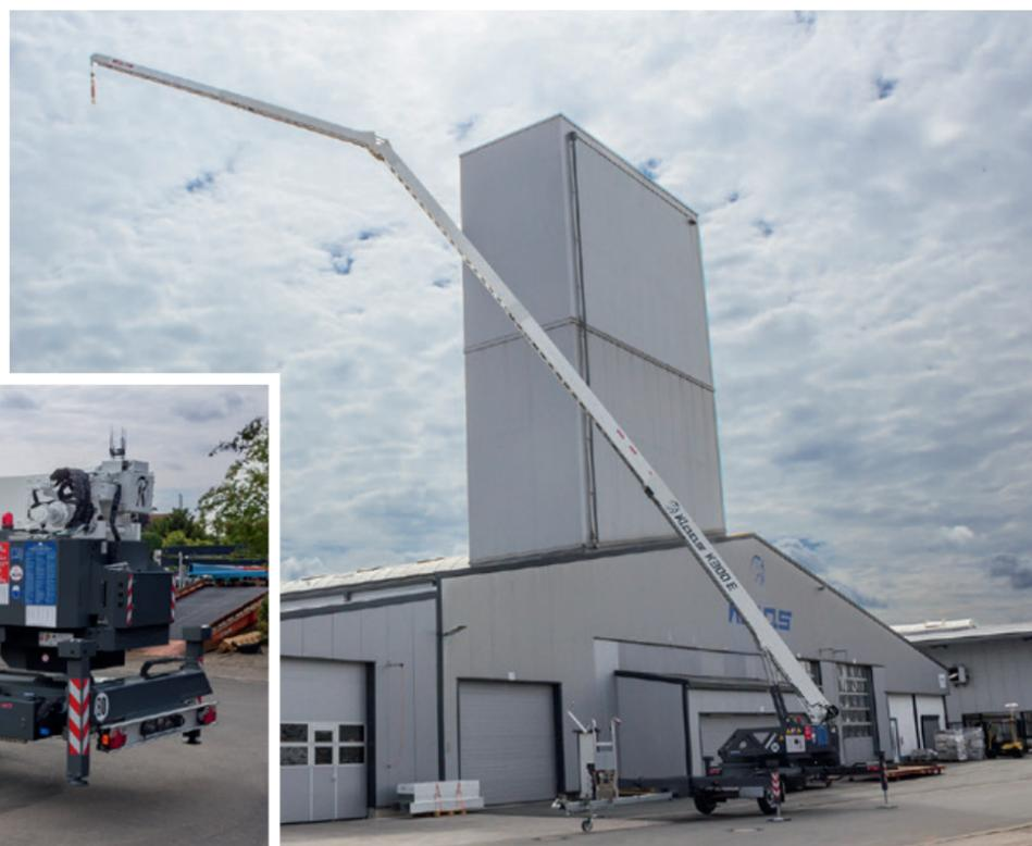
Der neue K300 E ist serienmäßig mit einer Aufbauautomatik ausgestattet.
