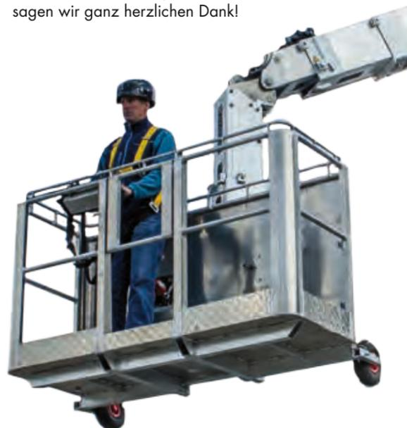
zugelassen. Sie ist einfach und werkzeuglos zu montieren und innerhalb weniger Minuten einsatzbereit. Auch diese Variante verfügt über normgerechte Verzurrpunkte und entspricht den strengen Sicherheitsstandards der EN 280. Über die Fernbedienung lässt sich die Bühne präzise und sicher bedienen, die Nivellierung erfolgt automatisch durch die Bühnensteuerung.
