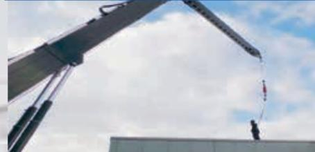
Ein weiteres Extra ohne Aufpreis: Die RSX-Modelle sind für die **Sicherung von Personen** gemäß BG-Richtlinien vorbereitet. Ein Höhensicherungsgerät, das mit dem Gurtgeschirr des zu sichernden Mitarbeiters verbunden wird, ermöglicht freies und sicheres Arbeiten an schwer zugänglichen Stellen.
