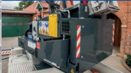
Grundsätzlich ist der Oberwagen aller Klaas Krane endlos drehbar. Bei den RSX-Modellen kommt jetzt neu die Funktion „**Winkelbegrenzung**“ hinzu: Über den Funksender kann der Schwenkbereich des Oberwagens gradgenau eingestellt werden. So lässt sich der Arbeitsbereich je nach örtlichen Gegebenheiten definieren und Gefahrenzonen können ausgeschlossen werden.
