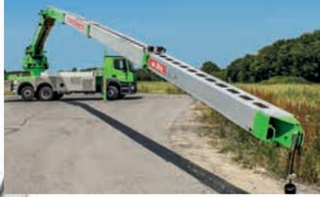
Die extrem starke **Klappspitze** besteht bei den RSX-Kranen aus einem Grundelement und drei Auszügen, von denen die ersten beiden hydraulisch teleskopierbar sind. Sie können per Fernsteuerung quasi „in der Luft“ ein- und ausgefahren werden. Dadurch ist der Kran nicht nur minutenschnell einsatzbereit, sondern lässt sich auch bei geringem Platzangebot aufbauen. Auch im Arbeitsbühnenbetrieb erweitert sich so das Reichweitespektrum.
