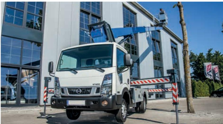
Der Aufbau der Arbeitsbühnen erfolgt bequem über die Fernsteuerung. Da die vier Stützen paarweise oder auch einzeln stufenlos ausgefahren werden können, passt sich der Theo optimal der jeweiligen Aufbausituation an. Die ASC-Steuerung sorgt für eine permanente Drucküberwachung während des Aufbaus und im Bühnenbetrieb. Neben der V-Abstützung garantiert sie damit jederzeit eine hohe Standsicherheit im Bühnenbetrieb und reagiert auf sich verändernde Bedingungen.
