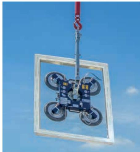
Vakuumheber vereinfachen die Montage von Wand- und Dachpaneelen sowie großer Glaselemente enorm und reduzieren den Zeitaufwand auf der Baustelle erheblich. In Aluminium-Leichtbauweise und für den Einsatz am Kran konzipiert sorgen sie für einen sicheren und zügigen Materialtransport. Vor rund zwei Jahren wurden die drei Vakuumheber CLAD-TEC, CLAD-BOY und CLAD-MAN aus dem Hause Aero-Lift ins Klaas Zubehörprogramm aufgenommen und erfreuen sich seitdem einer großen Beliebtheit.
