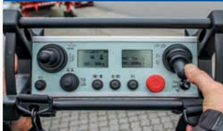
Klaas RSX-Krane verfügen standardmäßig über eine **XL-Fernsteuerung** mit zwei Displays, über die alle wichtigen Informationen auf einen Blick ablesbar sind. Eine integrierte Memory-Funktion im Hold-to-run-Modus erleichtert den täglichen Arbeitsablauf. Darüber hinaus sind diese Modelle so konzipiert, dass der Gebrauch mehrerer Fernsteuerungen an einem Kran möglich ist. Sie werden über handelsübliche Batterien betrieben, zum Standardpaket gehören ebenfalls Ladegerät und Akkus.
