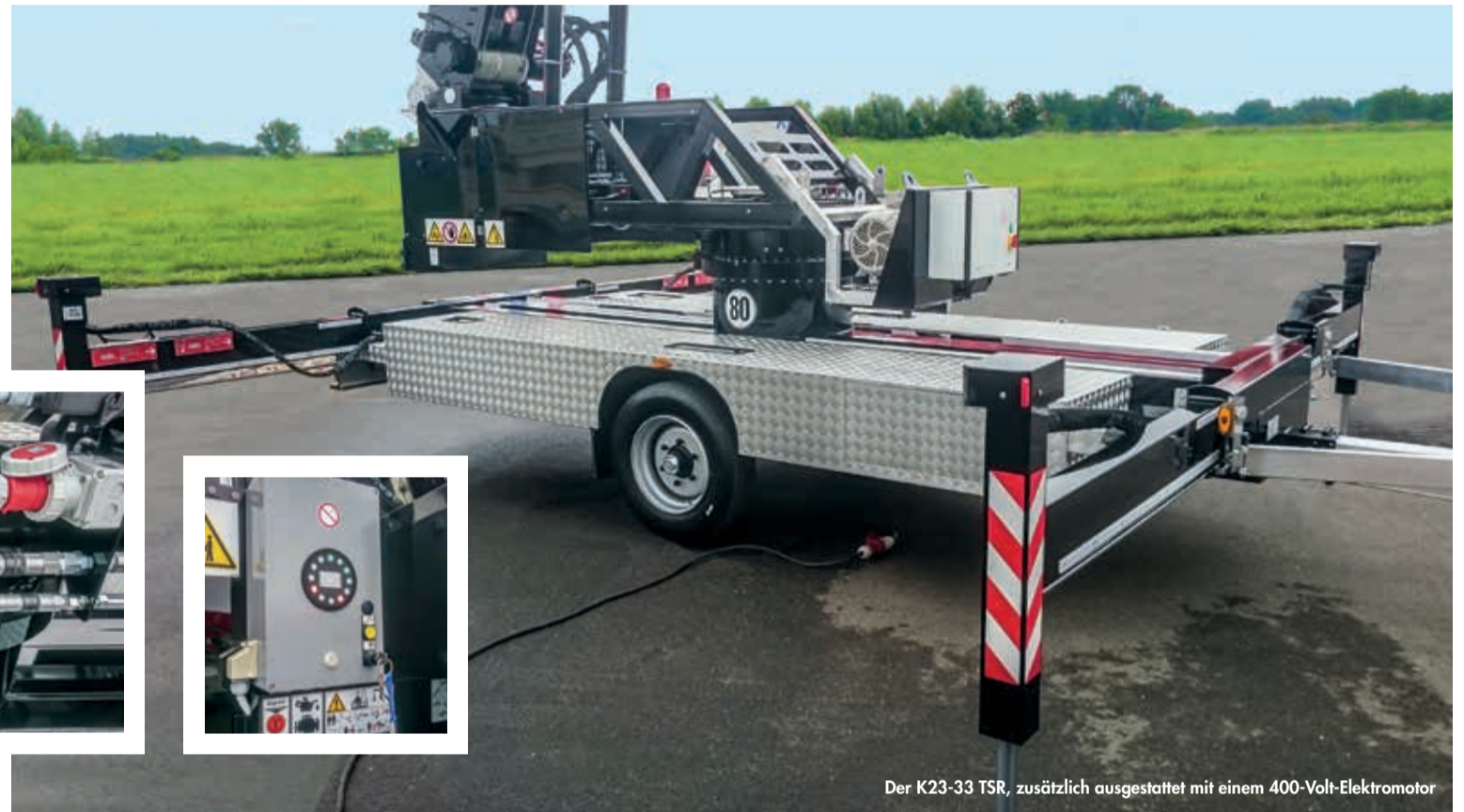
Für den Straßenverkehr ist der E-Motor mit wenigen Handgriffen und ohne Werkzeug abnehmbar.
