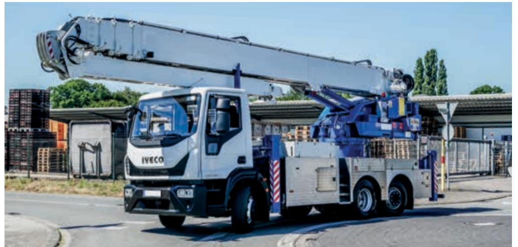
Die gelenkte zusätzliche Hinterachse sorgt für einen extrem geringen Wendekreis.
