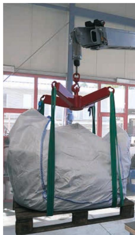
Klaas Krane in Verbindung mit dem passenden Zubehör optimieren die Arbeitsabläufe auf der Baustelle und reduzieren den Zeitaufwand enorm. Neu im Zubehörprogramm ist ein Hebekreuz, mit dem Material in sogenannten Big Bags transportiert werden kann. Dazu werden zunächst die Schlaufen des Big Bags in die vier Haken der Traverse eingehängt, anschließend wird diese mit dem Kranhaken aufgenommen. Über das Klaas Hebekreuz können Lasten bis zu 1.000 kg zügig und sicher an ihren Einsatzort bewegt werden.
