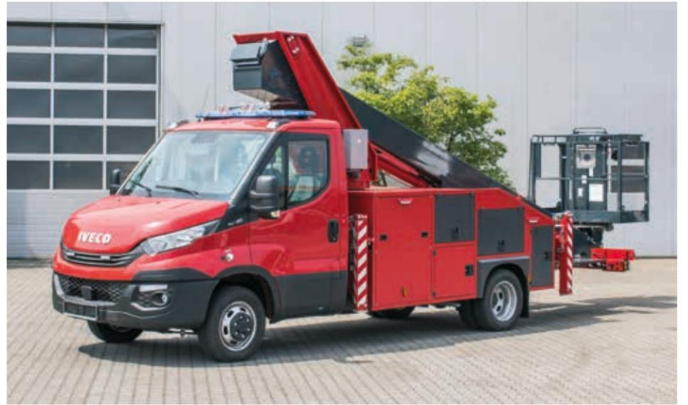
blechverkleidung, wurde beim Theo20 FW ein Podium der Firma Heinz Meyer Feuerwehrbedarf verbaut. Dadurch kann notwendiges Equipment für die verschiedensten Einsätze untergebracht und verkehrssicher verstaut werden. Als Trägerfahrzeug dient ein Iveco Daily mit einem zulässigen Gesamtgewicht von 4,6 Tonnen. In seinem Innenraum finden drei Einsatzkräfte bequem Platz. Integrierte Komponenten wie Funk, Navigation oder Bedienpanel für Sondersignale erleichtern die Bedienung im Einsatzfall.
