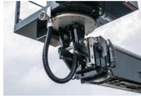
Über das C-Rohr können 400 Liter Wasser pro Minute ausgeworfen werden.
