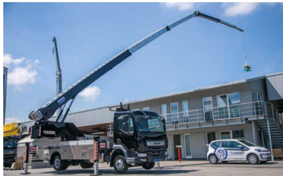
Geringe Aufstellfläche, enorme Reichweiten, hydraulische Klappspitze: Der K750 ist der ideale Kran bei geringem Platzangebot.
