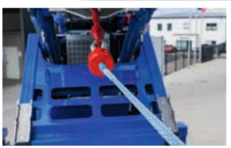
Das Hubseil aus hochwertigem Kunststoff spart Gewicht und optimiert das Hubverhalten.
