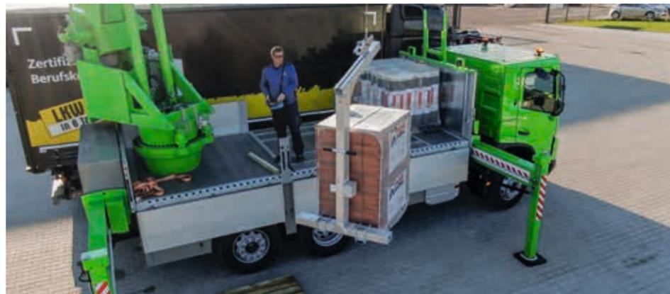
Zum Be- und Entladen können die hohen Ladebracken nach unten geklappt werden.
