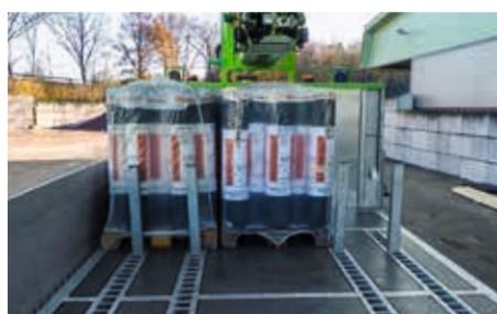
Über integrierte Schienen können die Baumaterialien verzurt und gesichert werden.
