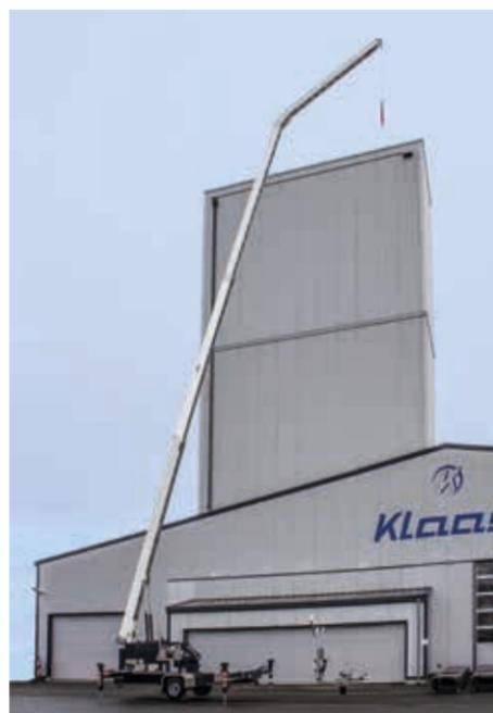
stabile H-Abstützung mit ASC-Stützenkontrolle, ein moderner CAN-BUS Steuerblock sowie die patentierte Klaas Seilwindentechnik garantieren sicheres und komfortables Arbeiten auf der Baustelle.
